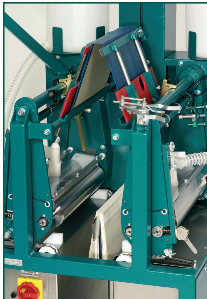
la colle dans la zone du mors. Cette épaisseur supplémentaire de colle appliquée dans la zone du mors peut être régulée indépendamment de l'épaisseur appliquée normalement, permettant de ce fait une meilleure adaptation de la gaze. La longueur du supplément de surface encollée peut également être réglée par le biais de l'unité de contrôle, de sorte que même un chevauchement large du mors ne pose aucun problème.
