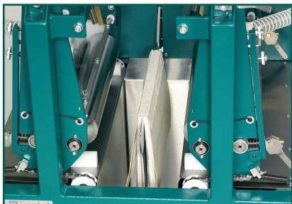
haute. Un corps d'ouvrage est ouvert au centre, placé sur la lame et poussé contre l'arrêt limite arrière. Un dispositif de détection du centre aide à l'ouverture du corps d'ouvrage, particulièrement pour les cas de changements constants de l'épaisseur des corps d'ouvrage.
