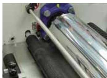
Le dispositif d'alimentation assure le transfert des feuilles de faibles grammage et des sorties numériques tandis qu'une cellule de détection évite les incidents.
