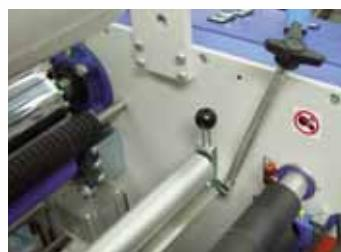
Un dispositif de détillage réglable pendant la marche garanti un résultat absolument plat en sortie.
