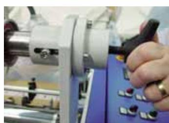
Le mandrin équipé d'un support basculant facilite la mise en place de la bobine. Le déplacement latéral du film en marche réduit sensiblement la gache papier.
