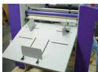
Les feuilles (jusqu'au format A2) sont automatiquement séparées en sortie grâce au dispositif réglable. Un coussin d'air transporte la feuille jusqu'au plateau de réception facilement ajustable.
