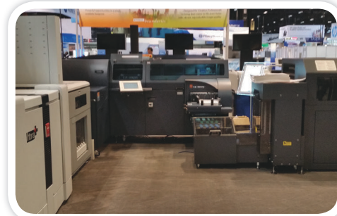
Océ VarioPrint série 6xxx travaillant en ligne avec un thermorelieur Bourq BB3202 et un massicot tri-lames CMT-130
