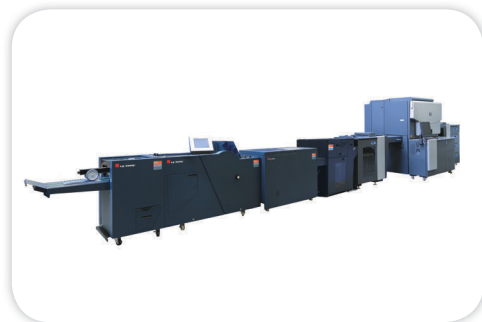
Module Bourq de fabrication de livrets brochés BM-e ExPress avec BSF travaillant en ligne avec une presse numérique HP Indigo 7800
