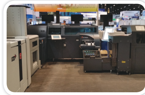
Océ VarioPrint série 6xxx travaillant en ligne avec un thermorelieur Bourq BB3202 et un massicot tri-lames CMT-130
