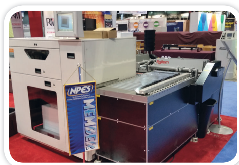
Margeur de feuilles Bourq BSF travaillant en ligne avec un chariot Rollem JetSlit
